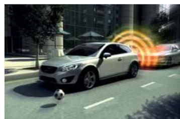
situado por delante del vehículo, combinando esa información con la de la velocidad y trayectoria. A partir de esto, ante la posibilidad de un impacto, advierte al conductor mediante señales acústicas y visuales. En el caso de que quien maneja ignore los avisos, se ponen en marcha los frenos de forma automática.
